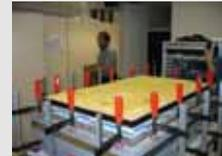
16cm Zellulose, 58kg/m<sup>3</sup>    0,141 m<sup>3</sup>/(h.m<sup>2</sup>)
