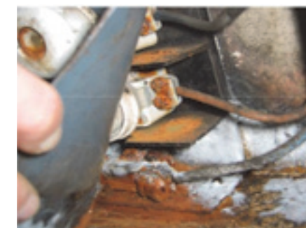
Bild 5: Brandgefahr Kondenswasserbildung
