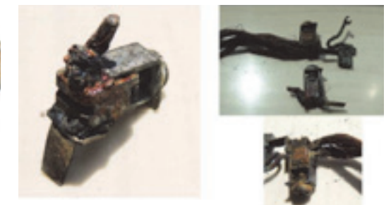
Bild 4: Kontaktierungsproblem bei Klemme
