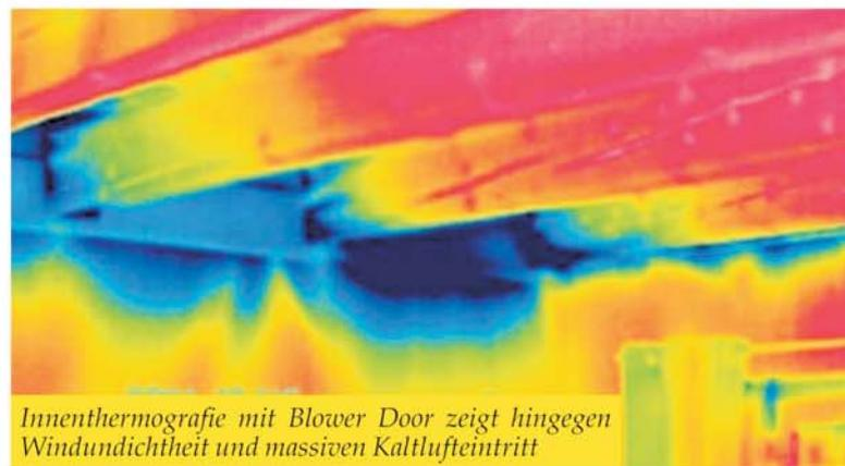
Innenthermografie mit Blower Door zeigt hingegen Windundichtheit und massiven Kaltluftzutritt
