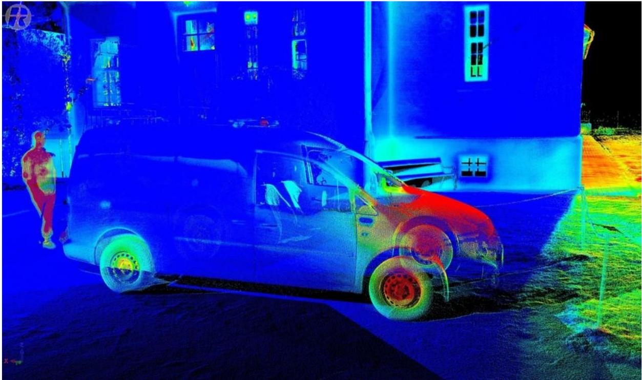
**Bild 1: Einfärbte 3D-Punktwolke des Laserscanners *RIEGL VZ-400i*, die Farbe entspricht der Oberflächentemperatur**
